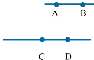
b. Coloque las puntas del compás sobre AB, sin cambiar la abertura apoye un extremo en C y marque un punto sobre la recta, llámele D.
