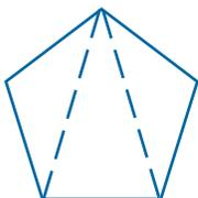
En un pentágono, al unir uno de los vértices con los otros no adyacentes, se forman tres triángulos y se tiene que el total de la suma de los ángulos internos para un pentágono será de:  $3(180^\circ)$ .
